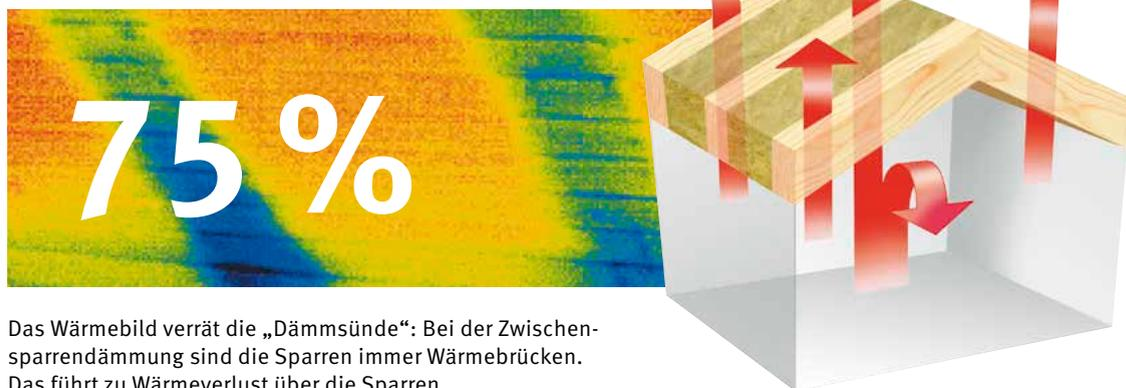
Das Wärmebild verrät die „Dämsünde“: Bei der Zwischensparrendämmung sind die Sparren immer Wärmebrücken. Das führt zu Wärmeverlust über die Sparren.
